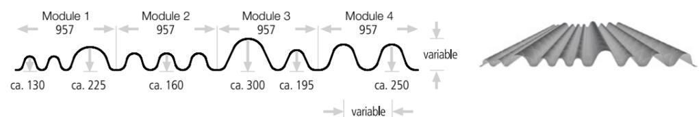
Noquets en trapèze ou en zigzag pour tous les profils. Les dimensions mentionnées pour la hauteur et la largeur des tôles ne sont qu'approximatives.
